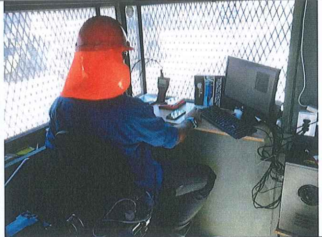
Foto N° 6 – Vista de Cabina de Protección desde donde son efectuados los ensayos y se registran los datos
